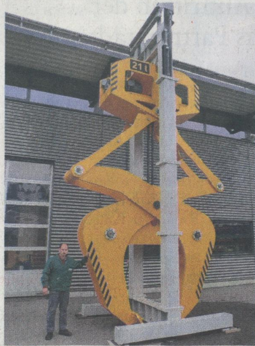
Werkstattleiter Walter Högerle zeigt, wie im neuen Prüfgerät der Firma Ematec (grau) riesige Zangen auf ihre Belastbarkeit getestet werden. Foto: Pagany
