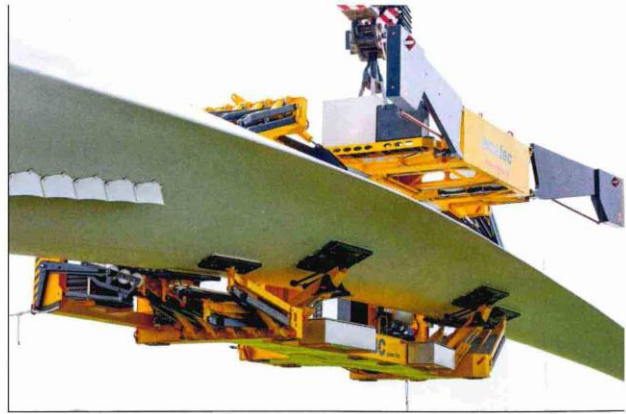
Links : In perfekter Balance: Über zwei Gegengewichte an den Traversenflügeln findet die RBC immer exakt den richtigen Schwerpunkt. Rechts : Neigungswinkel von \pm 30 Grad – für die RBC-Traversen von ematec kein Problem. Die Photos wurden im August 2020 am Lagerweg-Prototypen in Wieringermeer, Niederlande, aufgenommen.
