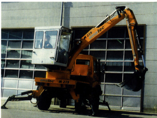
Huckepack: Auffällig an dem „schnellen Mobilbagger“ ist die rechts vom Baggerausleger montierte Kabine und die ungewöhnliche Reichweite des Auslegers.
